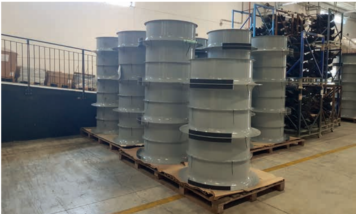
Turbinenrohre und Ansaugstutzen nach der Anlieferung
