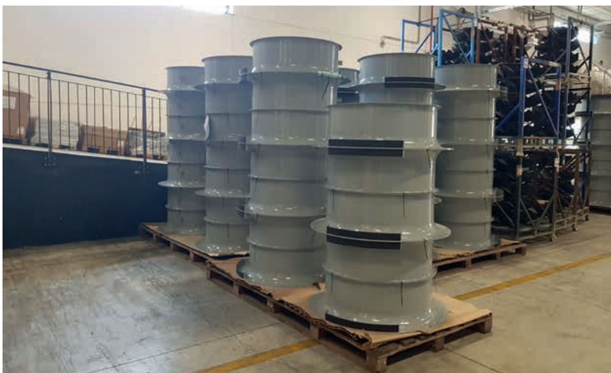
Convogliatori turbina e bocchettoni di aspirazione dopo la consegna
